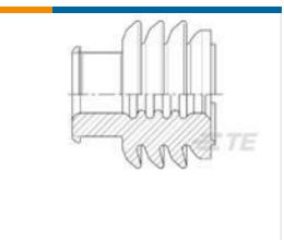
TE Model / Part #1355437-2 MCP9,5 EINZELDICHTG
