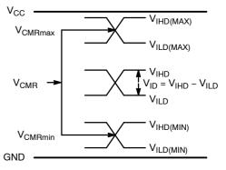
Figure 25. V<sub>CMR</sub> Diagram
